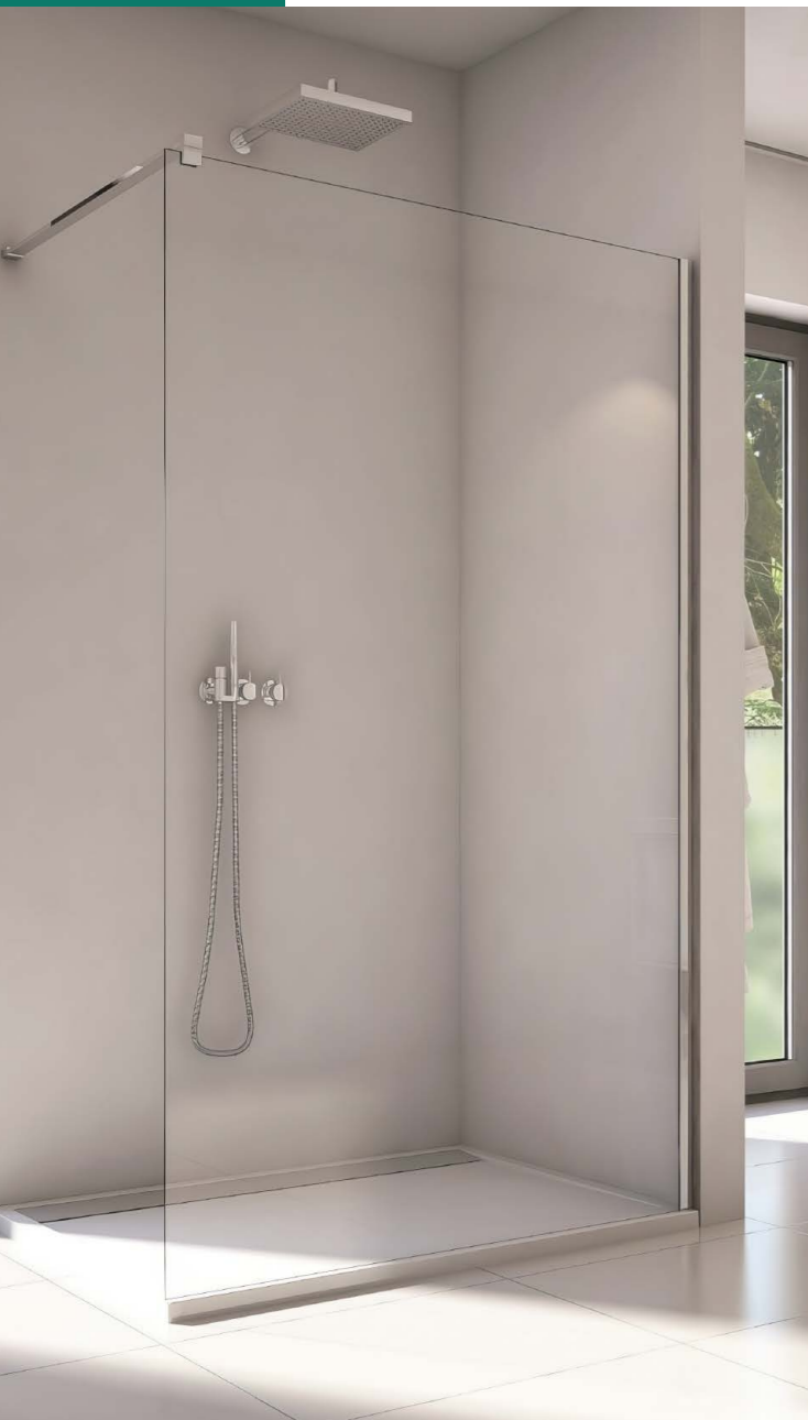
CONCEPT 200 Bezrámová konstrukce s jednoduchými madly a s pevnými designovými kotvícími profily. Bezpečnostní skla s antiplakovou úpravou Concept-Clean, standardní výška koutů je 200 cm, panty se zdvihovým mechanismem. (kód CON4P1205007, CONFP1205007)
